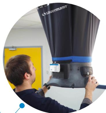
Controllo della portata aria all'ingresso e all'uscita di un locale, bilanciamento della ventilazione e calcolo del tasso di ricambio aria. Controlla anche temperatura e umidità.
