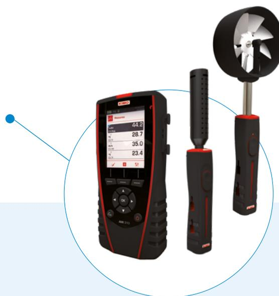
Misura della temperatura, umidità e tenore di CO<sub>2</sub> in un edificio.
