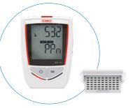
Registra la concentrazione di CO<sub>2</sub> (indice di qualità dell'aria interna e del tasso di ricambio aria) e la pressione atmosferica in qualsiasi tipo di laboratorio.
