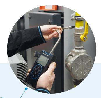
Rilevare perdite di combustibile come gas naturale, metano, propano, isobutano e GPL, in tutto il sistema di tubazioni gas.
