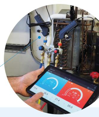
Questo strumento consente di mettere in servizio una pompa di calore, controllare la tenuta del circuito frigorifero o riempire il gas e controllare simultaneamente la pressione differenziale e le temperature di sottoraffreddamento/surriscaldamento.
