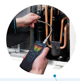
Rilevare le perdite di gas refrigerante in un circuito a pompa di calore.
