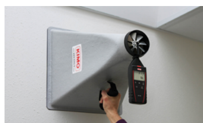
Prise de mesure de débit au cône à hélice
