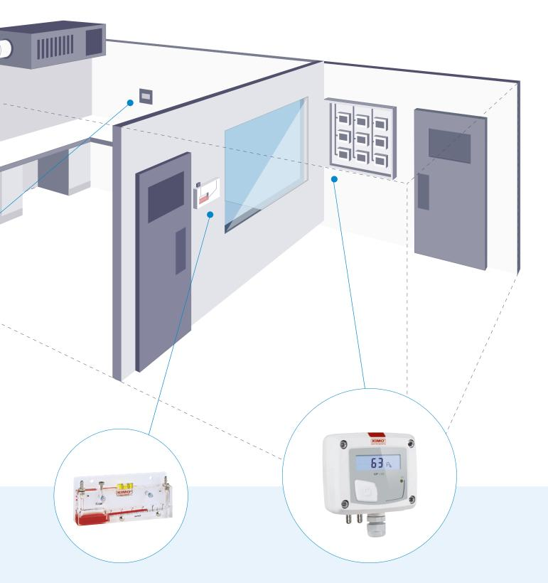
Para visualizar permanentemente la presión diferencial en la entrada de las salas limpias para los técnicos de laboratorio, sin necesidad de una fuente de alimentación.
