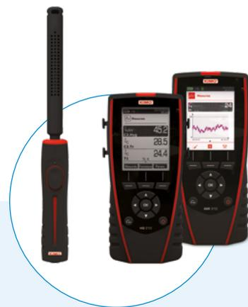
Mide los parámetros de calidad del aire del ambiente y de los conductos interiores del sistema de ventilación en cualquier tipo de edificio público.
