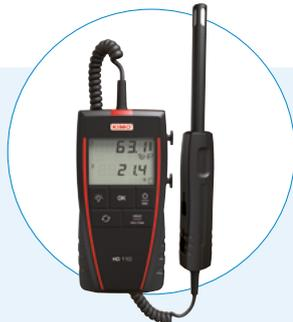
Mide la temperatura y la humedad en el aire ambiente, en las tuberías y en las salidas de aire.
