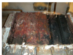
Corrosione o arrugginimento dell'ugello del bruciatore
