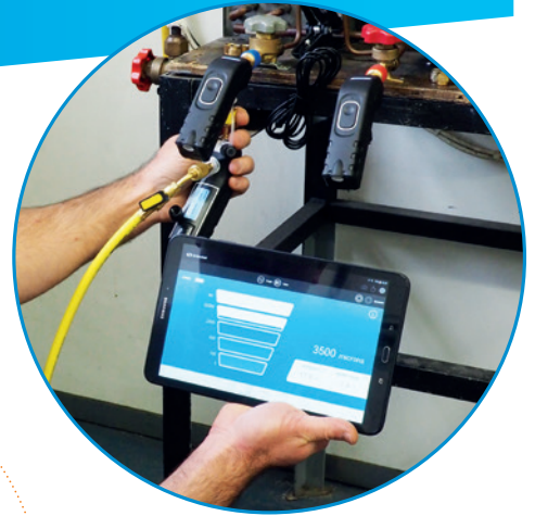
MEDICIÓN DEL VACÍO CON EL VACUÓMETRO SI-RV3
