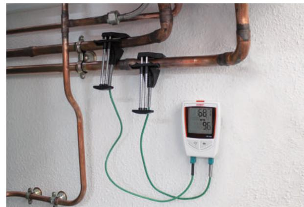
KTT 220 有 2 组热电偶温度探头接入端口
